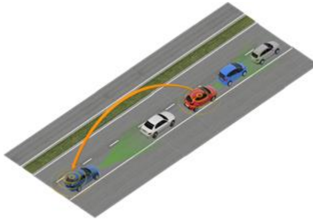
Abbildung 2.1: Übertragung von Sensordaten an nachfolgendes Fahrzeug (Kollektive Perzeption)
