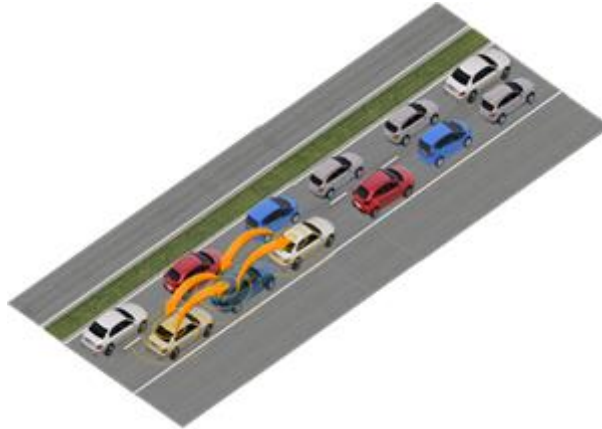
Abbildung 2.2: Kollektive Perzeption ermöglicht Staufolgekolonne mit verringertem Abstand
