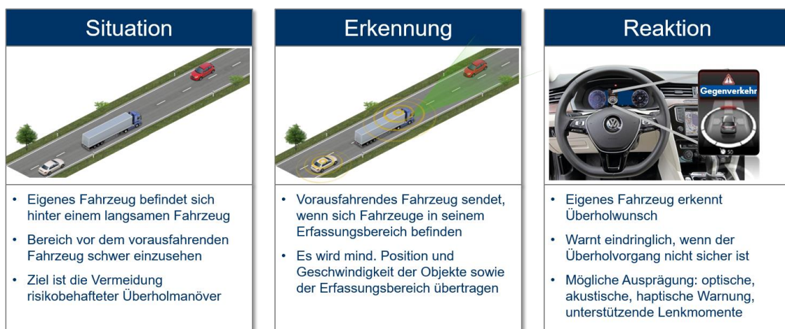
Abbildung 65: Funktionsweise der Kollektiven Überholwarnung
