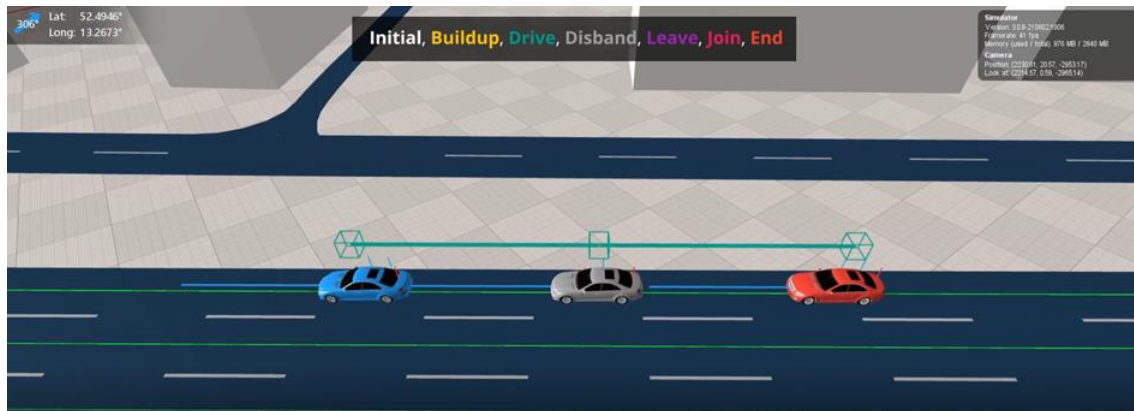
Abbildung 103: Platooning ist aktiv – Fahrzeuge mit gleichem Abstand
