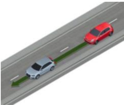
Abbildung 7: Plan-Trajektorie ist nicht mehr erlaubt, da nicht mehr kollisionsfrei. Es muss stattdessen eine kollisionsfreie Lösung gefunden werden.
