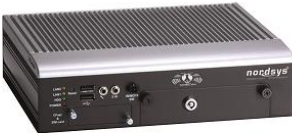
Abbildung 35: In IMAGinE eingesetzte Kommunikationshardware waveBEE
